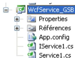
La définition du contrat –point C- d'un service passe obligatoirement par une classe interface. Si on ouvre l'interface (*IService1.cs*) on trouve du code par défaut :
