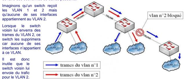
On active alors la fonction *VTP pruning* pour avertir le switch voisin de ne pas lui envoyer de trafic pour ce VLAN. La fonction s'active à partir du switch Server.
