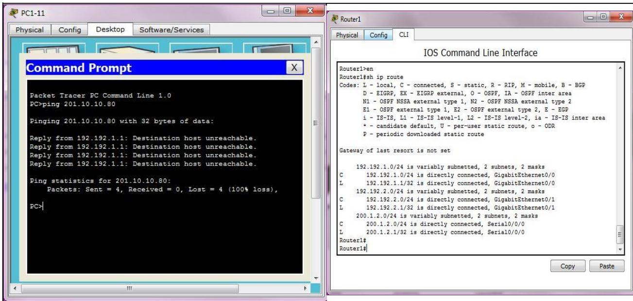
Un échange RIP, capturé grâce au mode simulation, permet de repérer le protocole et le port utilisé par RIP pour l'autoriser. Encore une fois, on profite des riches fonctionnalités de Packet Tracer.
