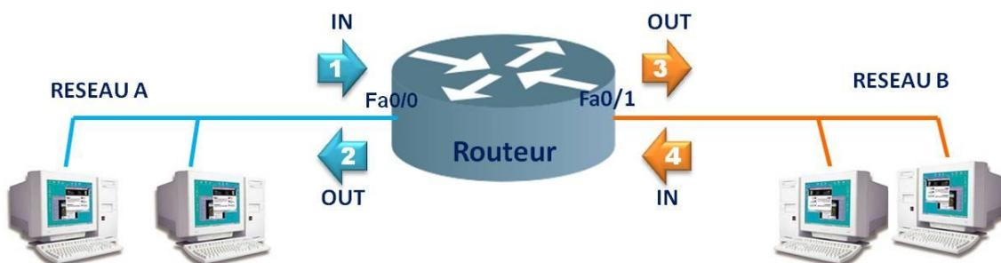
Pour un routeur muni de 2 interfaces, on peut donc filtrer – c'est-à-dire positionner une access-list – en 4 endroits :
