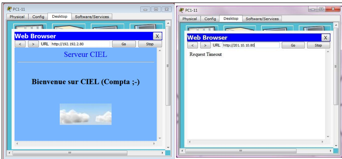
Pour être complet, il faut prendre le soin de tester également une communication du réseau COBALT vers le réseau CIEL et du réseau COBALT vers *le reste du monde*. Vous devez obtenir un résultat similaire : Réussite pour le test vers 192.192.1.80, Échec pour le test vers 201.10.10.80.
