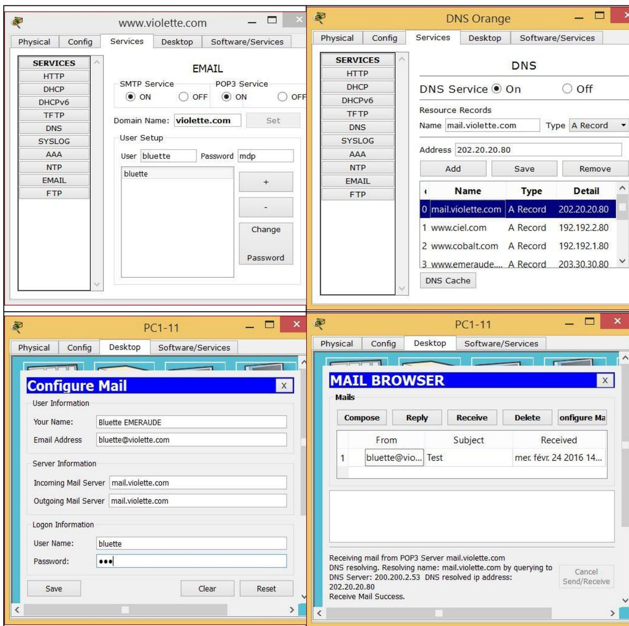
Ci-dessus, dans la 4<sup>ème</sup> capture, on voit que l'envoi et la réception ont fonctionné, puisqu'on a reçu le message de test que l'on s'est préalablement envoyé.
