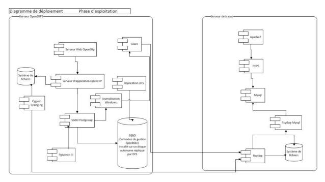
Pour un serveur Windows, on utilise donc le logiciel Snare pour rediriger les messages du journal du système d'exploitation vers le serveur de traces centralisé, et pour les applicatifs ne sachant pas travailler avec le système de journalisation Windows on utilise un serveur syslog-ng installé dans un environnement Cygwin (émulation d'un environnement Linux).
