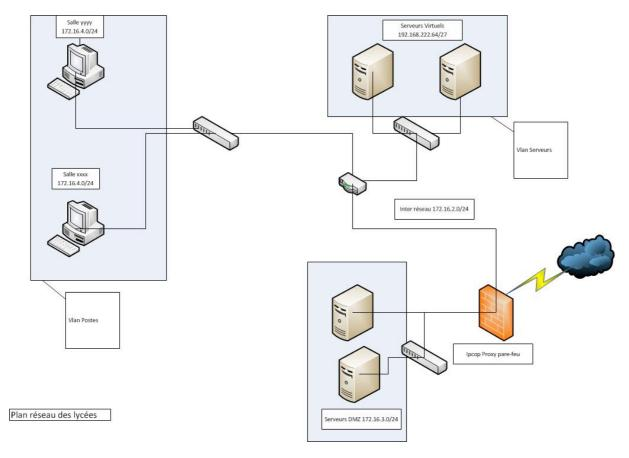
Les matériels d'interconnexion des différents Vlan entre eux sont des commutateurs CISCO 2960 et un routeur CISCO 2901. Les serveurs sont des serveurs virtuels hébergés dans une ferme de serveurs ESX composée de deux serveurs en cluster avec déplacement automatique des machines virtuelles en cas de problème sur un des deux serveurs ESX.
