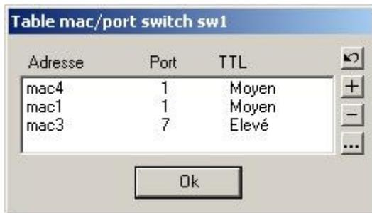
Chaque ligne est une entrée de la table mac/port du switch : Adresse mac, numéro de port et TTL (celui-ci évolue à chaque passage d'une trame dans le switch). Ces informations sont générées par le passage des trames (ou par la découverte du réseau) et peuvent être modifiées en mode Ethernet à l'aide du menu contextuel du switch.
